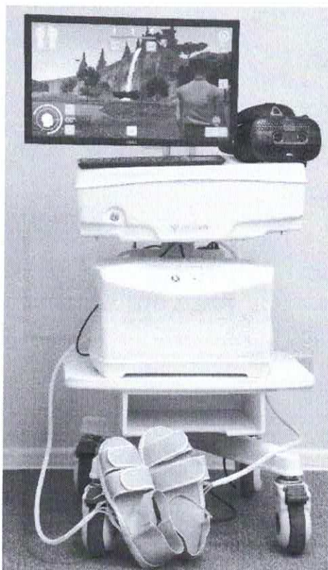
Рисунок 1. Мобильная стойка с системным блоком и монитором и прибор для создания давления с пневматическим модулем сенсорного воздействия на стопы
